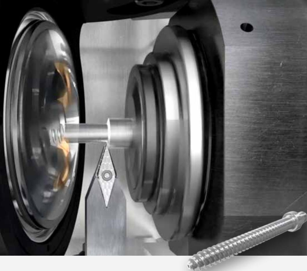
Le procédé de tourbillonnage à haute vitesse a été conçu pour la fabrication de vis à os, en tournage et tourbillonnage simultané. Pour la fabrication de composants à filetage, ce procédé est un atout notable qui se traduit par une réduction des temps de fabrication, des coûts et une durée de vie supérieure des outils.
