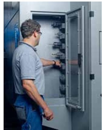
**Équipement pendant l'usinage grâce à la barre de chargement des outils :**
